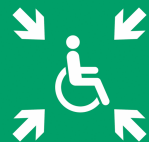
Illustrazione S.4-6: Esempio di spazio calmo (area of rescue assistance) secondo norma ISO 21542
