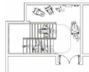
Illustrazione S.4-6: Esempio di spazio calmo (area of rescue assistance) secondo norma ISO 21542
