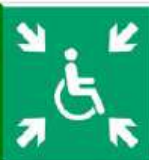
Illustrazione S.4-6: Esempio di spazio calmo (area of rescue assistance) secondo norma ISO 21542
