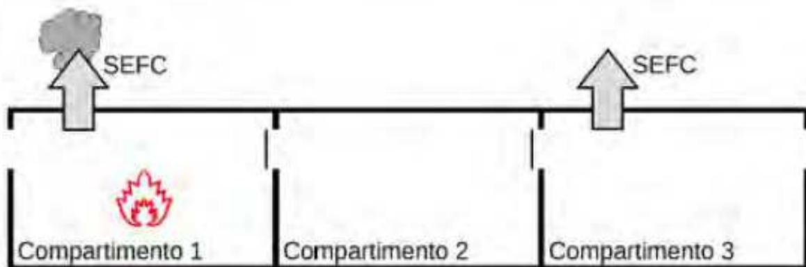
Il compartimento 2 è a *prova di fumo* proveniente dai compartimenti 1 e 3.
