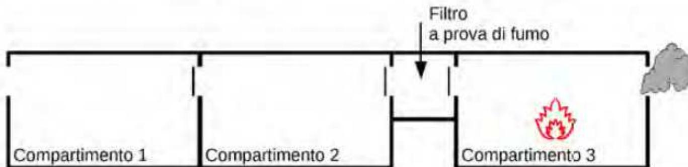
I compartimenti 1 e 2 sono a *prova di fumo* proveniente dal compartimento 3 e viceversa.
