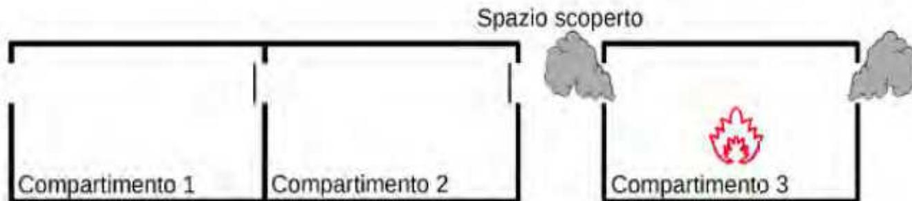
I compartimenti 1 e 2 sono a *prova di fumo* proveniente dal compartimento 3 e viceversa.
